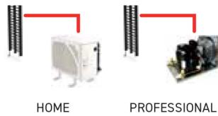
Le vetrine sono sprovviste di unità condensatrice. Tutte le vetrine vengono predisposte con valvola termostatica di serie. Le tubazioni per l'allacciamento alla linea frigorifera sono nella parte inferiore della vetrina. È necessario prevedere una linea di scarico per l'acqua di condensa e l'alimentazione elettrica.
